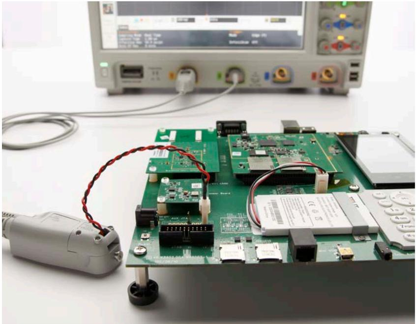
圖 1：Keysight N2820A/N2821A 高靈敏度電流探棒（解析度最低可達 50  $\mu\text{A}$ ）具有卓越的量測能力，很適合用來量測電池供電裝置常見的小電流。
