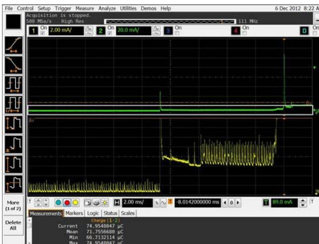
圖 5：Infiniium 示波器與 N2820A 電流探棒結合使用，可針對量測到的波形曲線進行區域面積計算，以便精確量測電流消耗。
