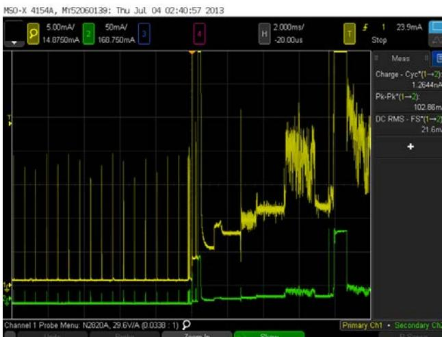
圖 6：Keysight InfiniiVision 3000 或 4000 X 系列示波器可與 N2820A/21A 電流探棒配對使用，以便在量測動態範圍更寬的電流時，同時提供低增益和高增益檢視模式。
