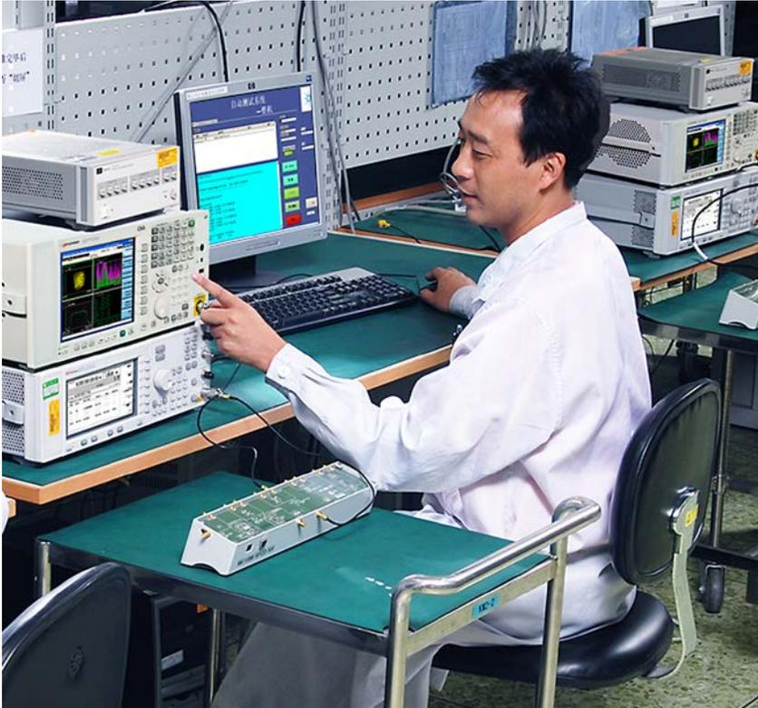
不論是快速更新下一代產品，或是修改現有的產品設計，Keysight CXA 可讓您更輕鬆地完成信號特性分析，以便測試、驗證產品設計並排除障礙。CXA 的內建功能可支援頻率、位準、突波及失真等重要量測作業，而且可全程控制在預算範圍內。
